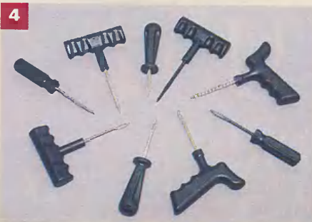
Инструменты для обработки прокола и протаскивания жгутиков. Т-образные ручки удобнее.
