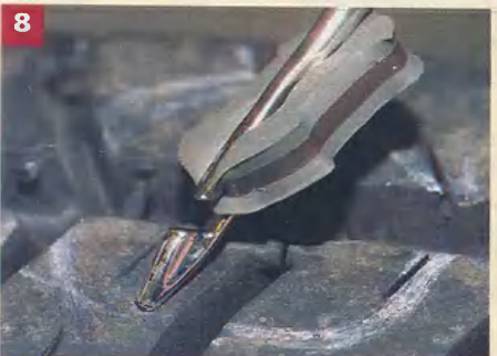
Якоря для ремонта диагональных шин вставляем иглой с боковой прорезью.
