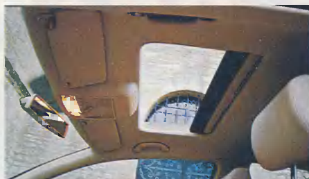
Зеркало с автоматическим затемнением, люк с сервоприводом – все как у «взрослых»...
