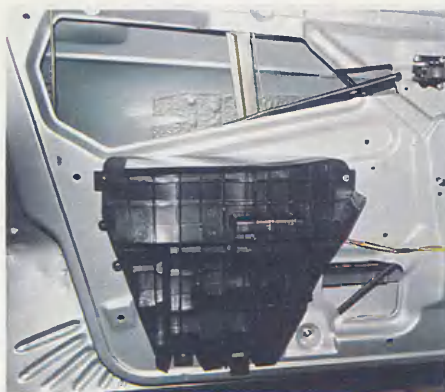
Дверь «десятки» с пластиковой вставкой, смягчающей боковой удар.
