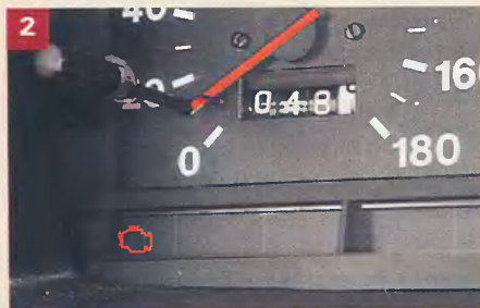
Индикатор неисправности на панели приборов.
