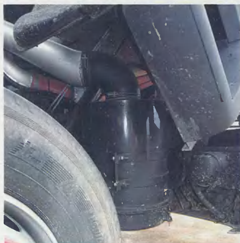
Расположение воздушного фильтра подра- зумевают только хорошие дороги.
