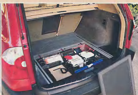
Для лучшей развесовки аккумулятор помещен в багажник, а запасное колесо подвешено снаружи под днищем.
