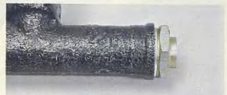
Выступ на гайке – признак цилиндра для ГАЗ-24! На более поздние «волги» он не годится.
