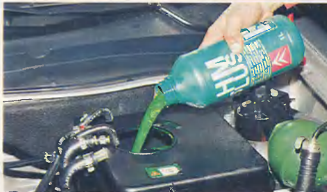
LHM – рабочая жидкость единой гидросистемы.
