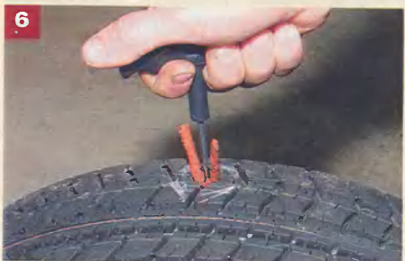
Вводим жгут в отверстие.
