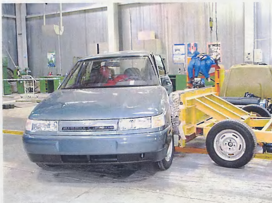
Боковой удар автомобиля ВАЗ-2110 по Правилу № 95 ЕЭК ООН.
