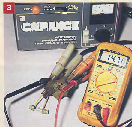
При проверке регулятора напряжения источником тока может служить зарядное устройство.
