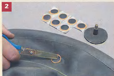
2 Холодный ремонт с помощью специальных заплаток и клея.
