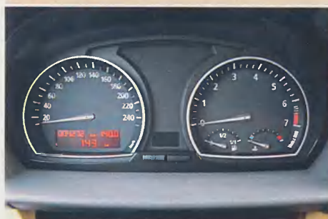
На приборной панели остались две большие шкалы, а пара указателей приютилась в нижней части тахометра.
