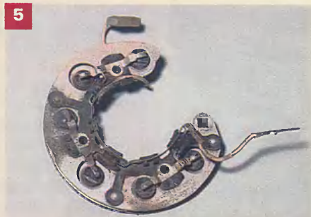
Этот алюминиевый радиатор блока диодов уже начал окисляться.
