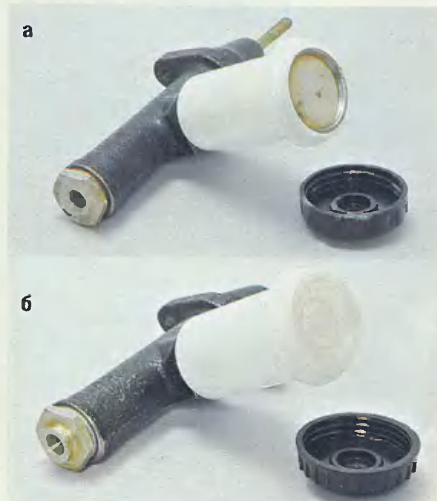
У бачка, купленного для «Фенокса», внутри сеточка (а), у остальных (б) – пластик с дырочками.
