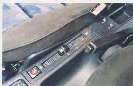
Кран управления подвеской имеет четыре положения.
