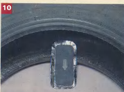
Заплатку ориентируем по направлению нитей корда покрышки.
