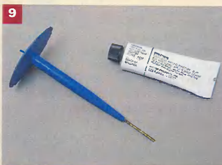
Вариант «грибка» для ремонта проколов на размонтированной покрышке.
