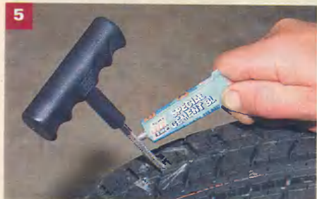
Прочистив отверстие, смазываем клеем.
