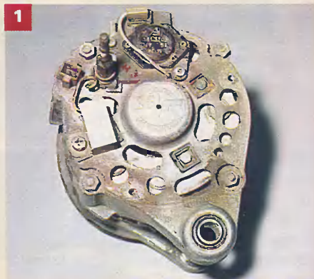
Регулятор напряжения расположен на задней крышке генератора.
