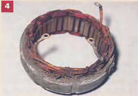
Обмотка статора склонна к загрязнению.
