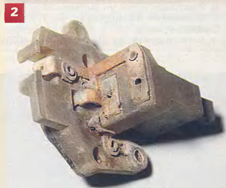
Типичная неисправность – окисление контактов.
