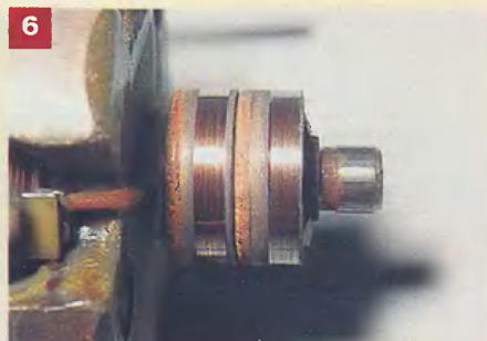
Контактные кольца ротора могут быть значительно изношены.
